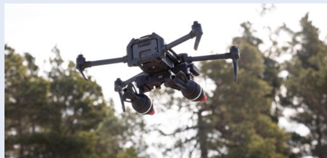
Drönare beväpnad med tillsats för granater. Foto: Försvarsmakten
